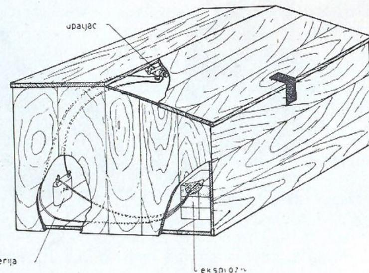
Sl. 68. Mina naoružana baterijskim upaljačem pripremljenim na podizanje-spuštanje
